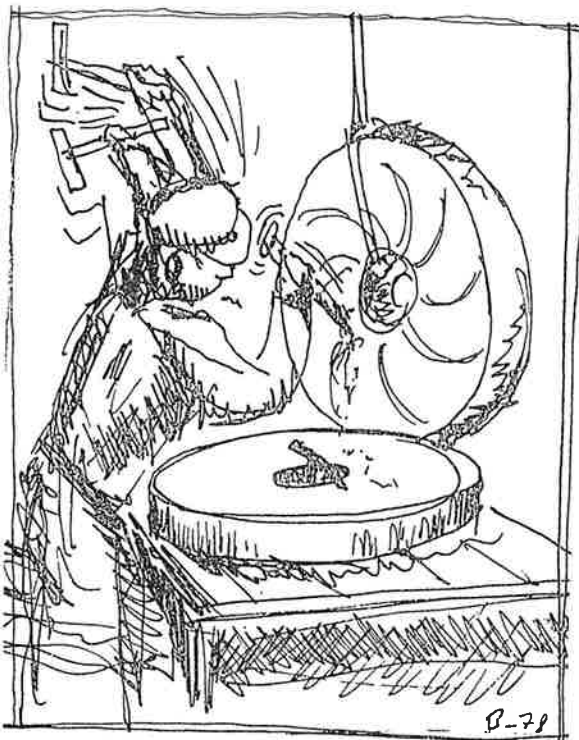
Fig. 31. Oversteinen er løftet og den seige massen hugges ut. (Berge: Vitenskapen som felleiseie)
