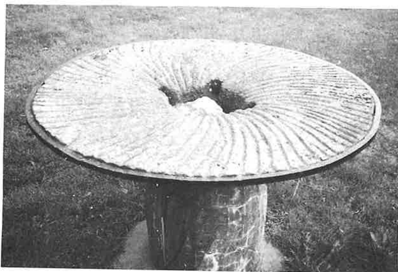
Fig. 7. Mange kvernsteiner finnes enda som hagebord i Høvåg. Her er hagebordet på Isefjær. En ser at steinen har riller som står meget tett. Rundt kanten ligger jernringen som skulle hindre steinen i å sprekke, og i midten kan en se sporene etter opplagringen, «segle».
