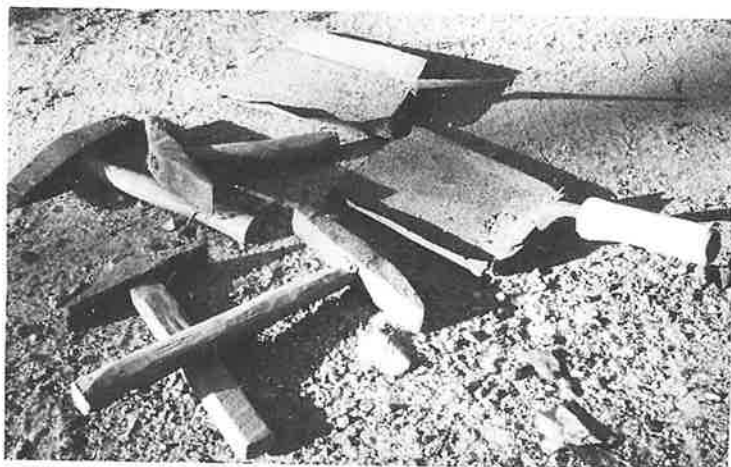
Fig. 35. Redskap. Hammerne var til å hugge ut riller med. Skuffene var til å øse gryn og mel med.
