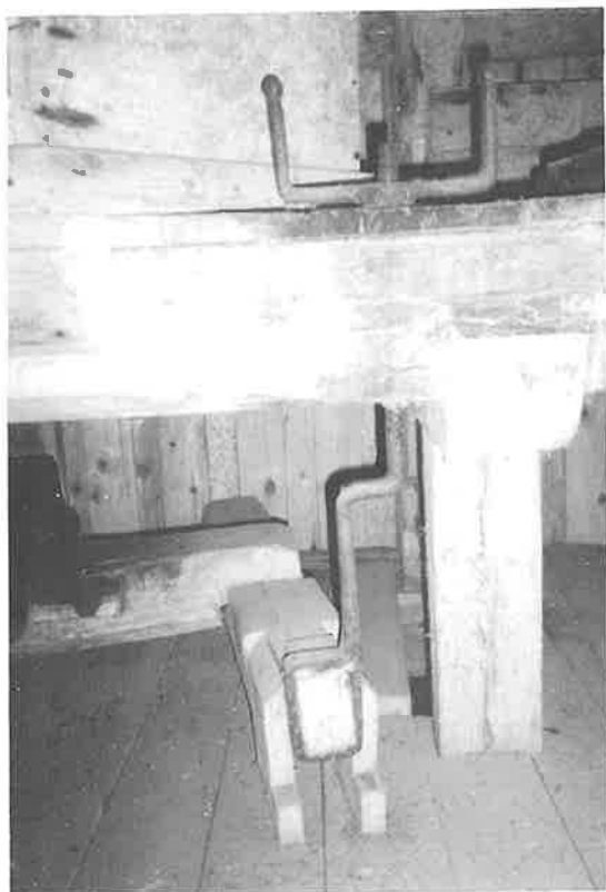
Fig. 30. Oversteinen kan heves og senkes ved å dreie på dette jernhåndtaket.
