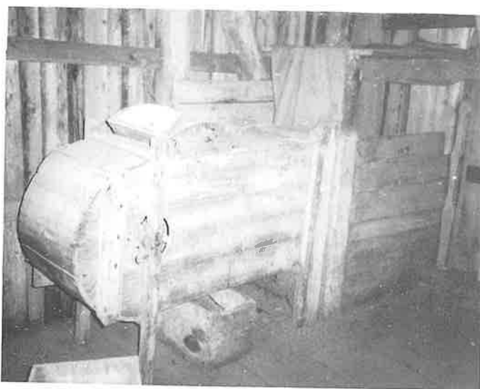
Fig. 28. Aspiratøren eller resemaskinen. Korn og skall ble tømt i trakta øverst og gikk forbi vifta. Kornet falt ned i kassa under, mens skallet havnet i bingen til høyre.
