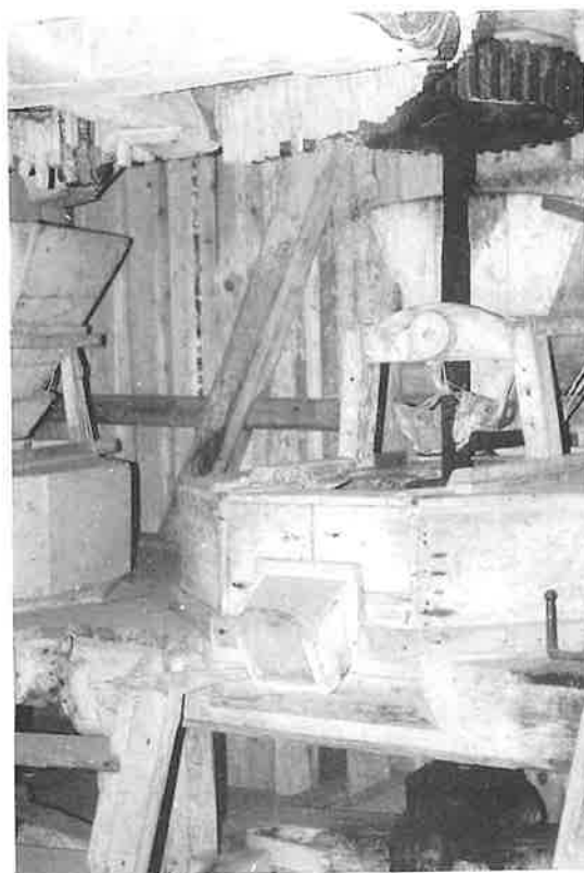
Fig. 33. Fra det store drivhjulet overføres kraften til mindre tannhjul av støpejern.
