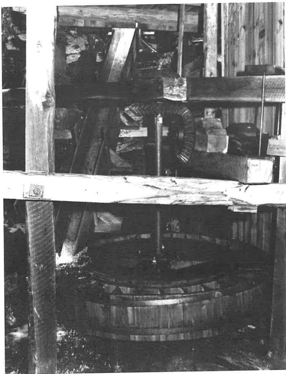
Nærbilde av vannhjulet som driver Kornbrekkesaga. Hjulet er en "folkeutgave" av Borda-turbinen, en fransk konstruksjon fra sist på 1700-tallet. Hjul av denne typen ble sagt å gi "møe kraft med lide vann". Et sett koniske tannhjul fører rotasjonen over til en horisontal aksel som går inn gjennom veggen til høyre, og videre med flatreim og reimskiver til sagbladet. Foto: Lillesands-Posten.
